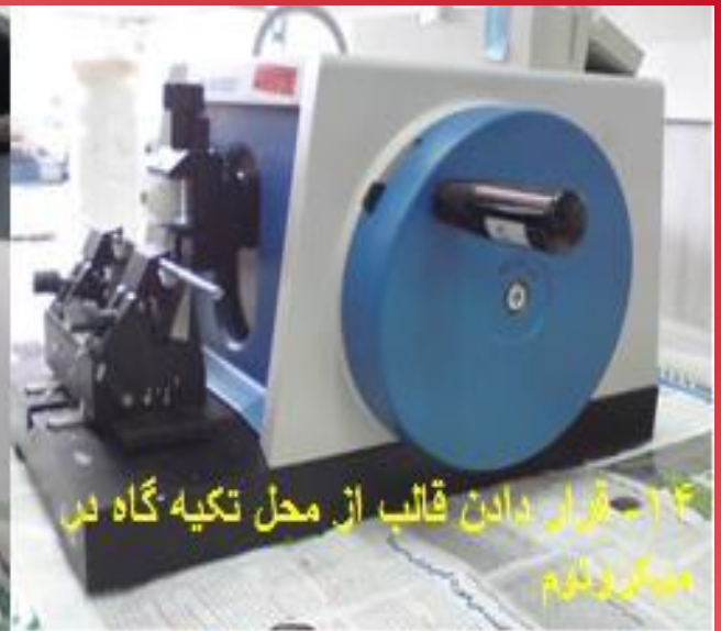
۱۵- تنظیم برشگیری با ضخامت ۵ تا ۷ میکرون به صورت پشت سر هم
